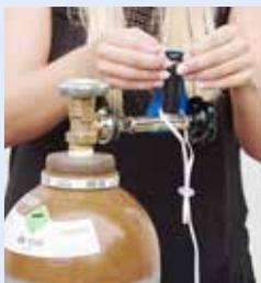
Flaschenventil (langsam!) öffnen und Verbindung auf Dichtigkeit prüfen.
