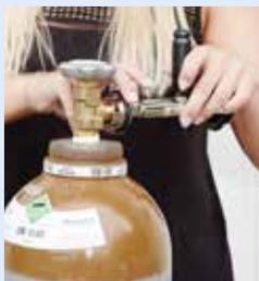
Flasche vor dem Umfallen sichern, Flaschenkappe abschrauben. Füllventil nur mit der Hand auf das Flaschenventil schrauben (kein Werkzeug verwenden!). Füllventil schliessen (falls offen).
