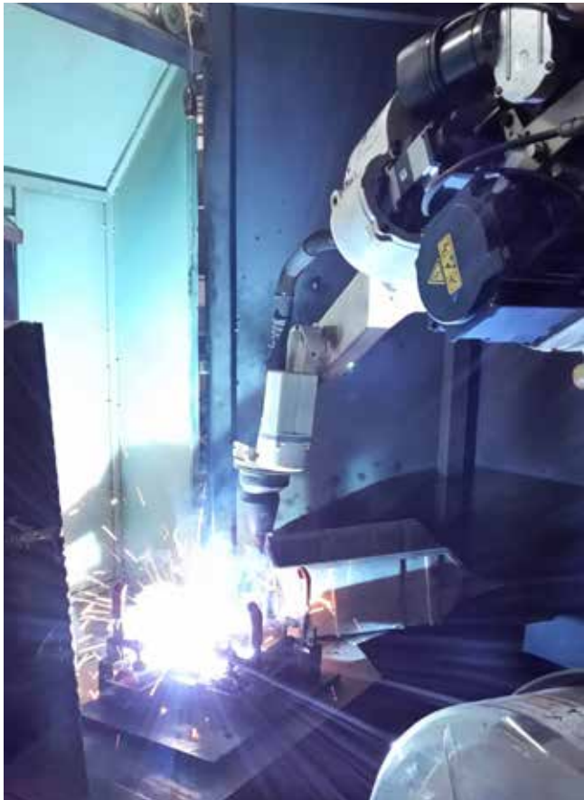
Mechanisiertes MAG-Schweißen mit Ferroline C18
